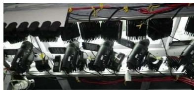
覆工用4Kカメラ11台+路面用カメラ2台
