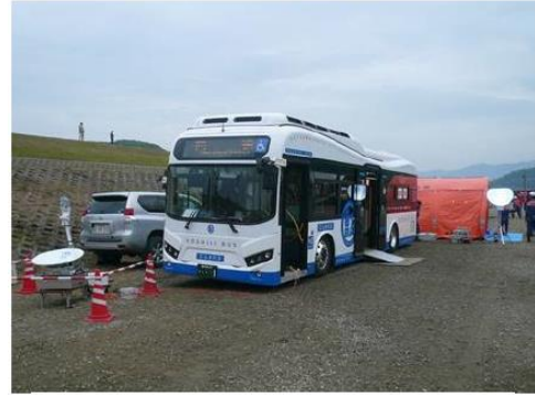
電気バスから非常用電源の取出し
