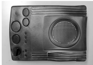
落雷で黒焦げのIP音声告知端末
