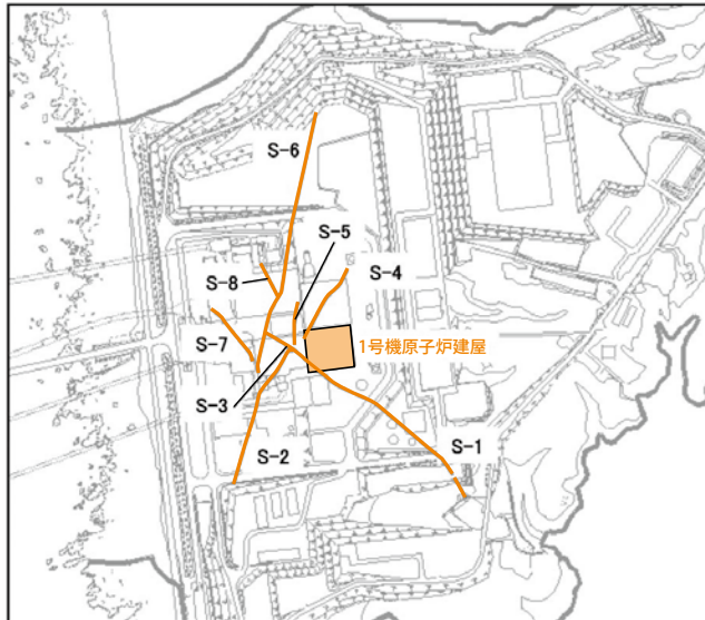
敷地内シームの分布状況
