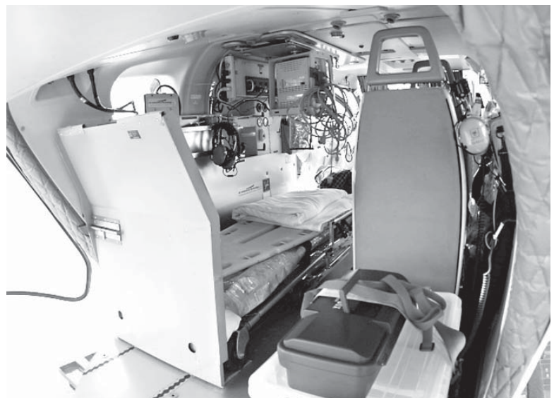
後部ドアより機内内部。医療器材を常時装備しており、搬送のみでなくいち早く初期治療を行える。(写真提供：E&M 研究所)
